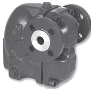
Поплавковый конденсатоотводчик с шаровым поплавком и звещающим шаровым клапаном и Duplex гарнитурой (термостатическим элементом для автоматического отвода воздуха) для отвода большого количества конденсата.
